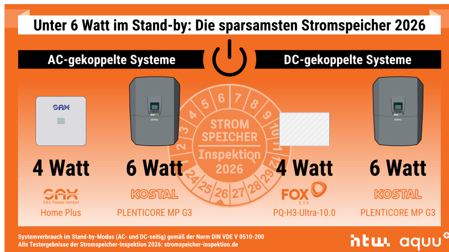
Bild 25 Gleich 4 Solarstromspeicher konnten im Rahmen der Stromspeicher-Inspektion 2026 eine Stand-by-Leistungsaufnahme bei entladenem Batteriespeicher von unter 6 W vorweisen.
